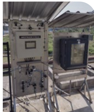
Amostrador à vácuo para coleta de efluente, para analisador de DQO
